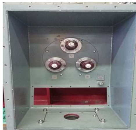
Вид внутри главной коробки выводов
