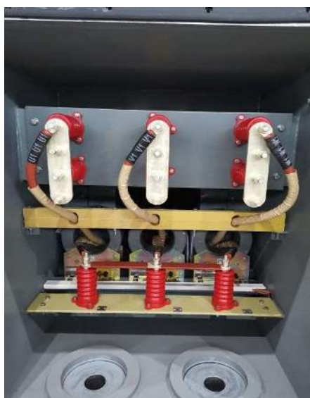
Вид главной коробки выводов внутри
